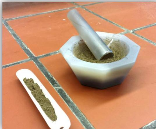
Abb. 3: Reaktionsmischung in Porzellanschiffchen und Achatmörser.
