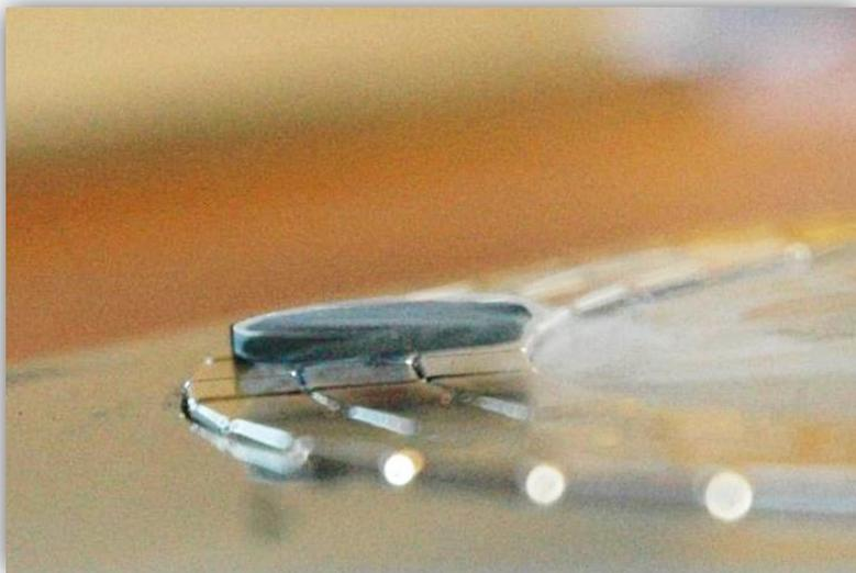
Abb. 1: Keramischer Hochtemperatur-Supraleiter ( $\varnothing$  1 cm).
