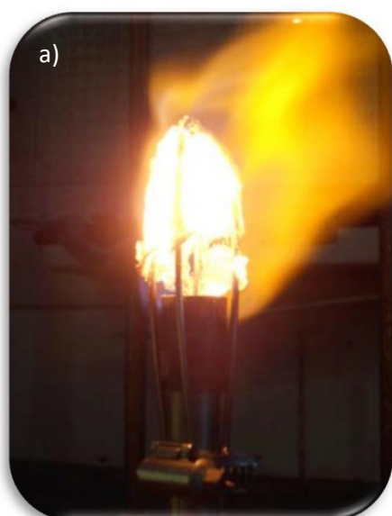
Abb. 4: a) Teclubrenner mit Drahtvorrichtung und Glühstrumpf. b) Reaktionsgleichung 2: Oxidbildung aus den Metallnitraten unter Abgabe von Stickoxiden ( \text{NO}_x ) und Sauerstoff ( \text{O}_2 )
