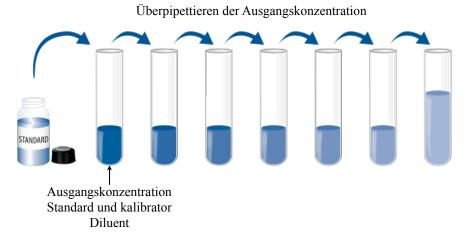
Abbildung 8 : Pipettierschema zur Herstellung einer Standard-Verdünnungsreihe.
