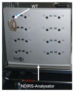
Abbildung 11: NDIRS-Analysator inklusive Wasserdampfaustauscher (WT) (87).
