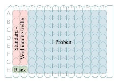
**Abbildung 9** : 96 "Well"-Mikrotiterplatte mit aufgezeigten Pipettierschema. Alle Flüssigkeiten wurden in doppelter Ausführung pipettiert.
