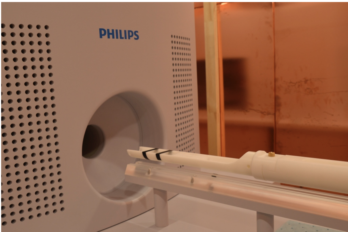
Abbildung 9: MPI Scanner an der Charité Berlin. Phantome oder Versuchstiere können auf das Kunststoffbett gelegt und in den Scanner geschoben werden.
