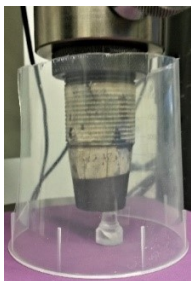
Abb. 19: Versuchsaufbau Druckfestigkeitsprüfung: PMMA-Stumpf mit Platte, KATANA™ STML Gerüst 0,4 mm (Probe 8) mit 8,0 mm Kugel vor und nach der Bruchfestigkeitsprüfung (v.li.n.re.), digitale Fotos
