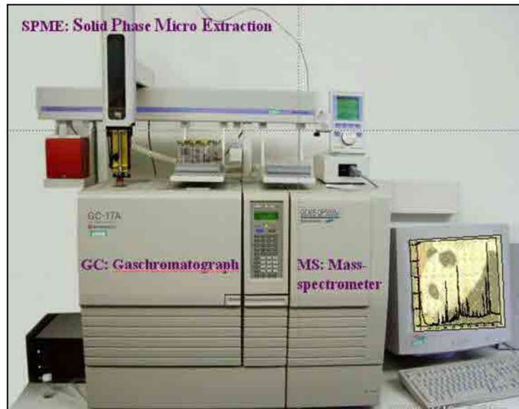
Abb. 4-9: Anordnung der SPME mit Probenanreicherung und GCMS
