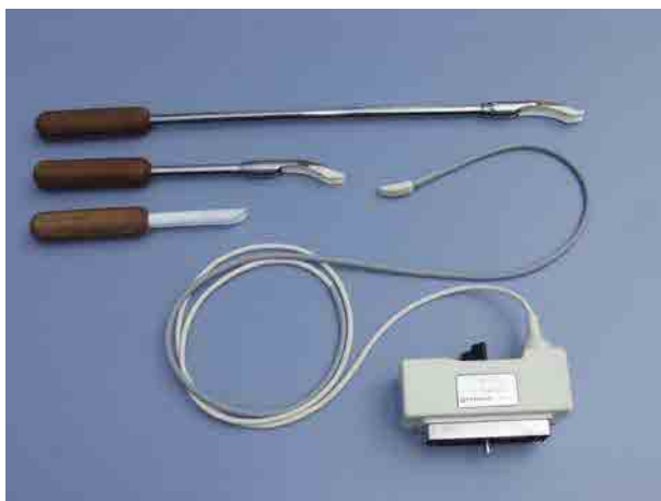
Abb. 4-3: 7,5 MHz Mikrokonvex-Schallkopf mit verschiedenen Führungshilfen. Der üblicherweise verwendete 50 cm Adapter befindet sich im Bild ganz oben.
