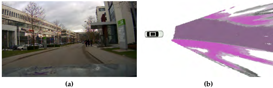
Abbildung 2.13: ScanGrid, erstellt aus einer semantischen Punktwolke. (a) Kamerabild der Situation. (b) ScanGrid m_t^{SS}(\cdot) mit den 'belief masses'. Jedes Pixel repräsentiert eine Gridzelle. Die Farbe kodiert die Hypothese (Lila: \{M, L\} ; Magenta: \{S\} ), die 'belief mass' ist als Transparenz des Pixels (Alpha-Kanal) dargestellt.
