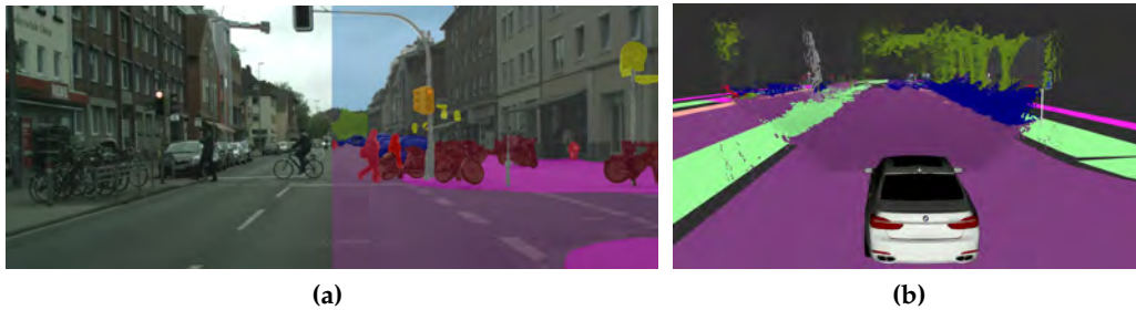
Abbildung 2.9: (a) Ein Kamerabild mit einer Überlagerung der semantischen Segmentierung in der rechten Bildhälfte (Re-Implementierung des PSPNet). Die Klasse ist durch die Farbe des Pixels gegeben. (b) Überlagerung einer hochgenauen Offline Karte mit der semantischen Punktwolke. Die Farbkodierung der hochgenauen Karte entspricht der der semantischen Segmentierung.
