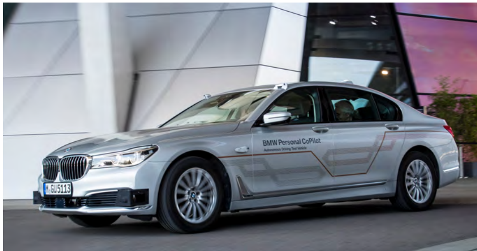
Abbildung 5.1: Photo des verwendeten Versuchsfahrzeug. Es kam ein modifizierter BMW 7er (G12) zum Einsatz, der mit entsprechenden Sensoren zur Umfelderkennung ausgestattet ist. Das Fahrzeug besitzt ein elektronisch steuerbares Lenk-, Brems- und Antriebssystem. Es ist damit in der Lage, automatisiert zu fahren (Quelle [183]).
