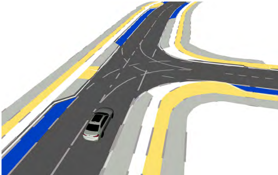
Abbildung 5.4: Ausschnitt der verwendeten HD-Karte für eine innerstädtische Verkehrssituation während der Fahrt. Dargestellt sind neben dem Ego-Fahrzeug (Auto-Modell) die einzelnen Fahrstreifen (dunkelgrau), die Fahrstreifengrenzen (graue Linien), Bürgersteige (gelb) sowie Parkbuchten (blau).
