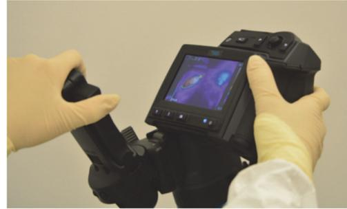
Abbildung 10: Digitalbild der Wärmebildkamera FLIR T660 (Foto von Kerstin Fiebig).
