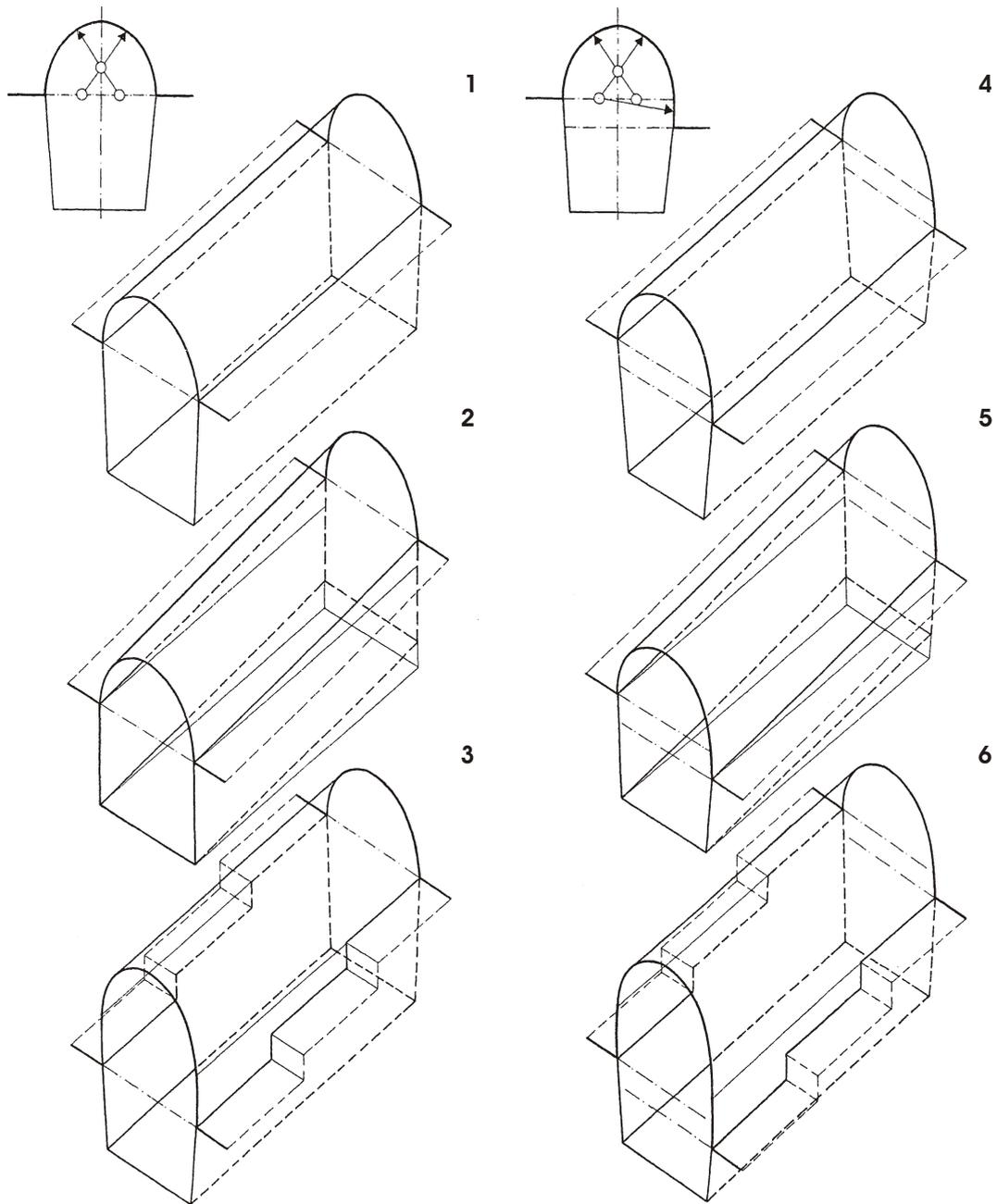
Abb. 41 Tonnen über durchgehenden Auflagern. Darstellung von N. Baimatowa
