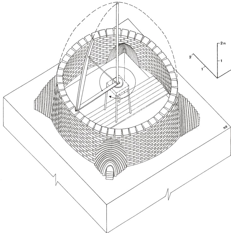
Abb. 30 Errichtung einer Kreiskuppel mit Hilfe einer Halblehre nach Usto Kurban Juldashev.
