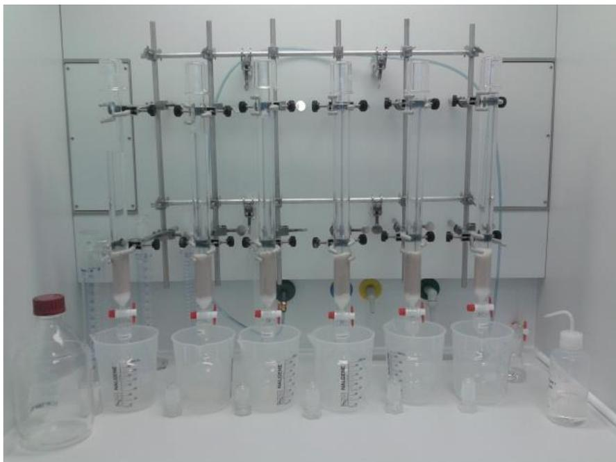
**Abbildung 7: Sechsfach Ansatz der Ernst'schen Säule zur Fettextraktion aus Unterhautfett**
