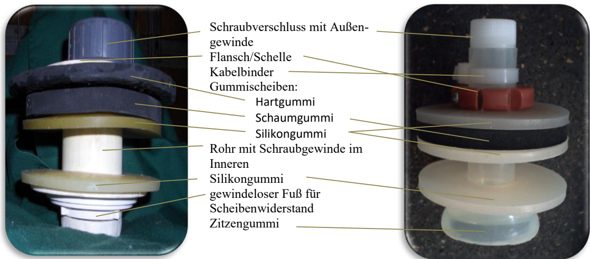
Abbildung 5: Aufbau der verwendeten Pansenfistelkanülen nach Alert (2008)
