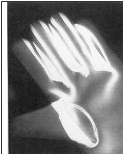
Abb.44: Genähter Handschuh - jedes Nahtloch ist ein Strahlenleck. (HARTUNG 2000 (67), S. 128)
