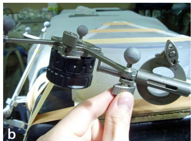
Abbildung 3.10: Einstellung VarioGuide: (a) Screenshot mit Einstellungsanweisung, der grüne Punkt markiert eine korrekte Einstellung; (b) Einstellung des Joint 2 während eines Modellversuchs
