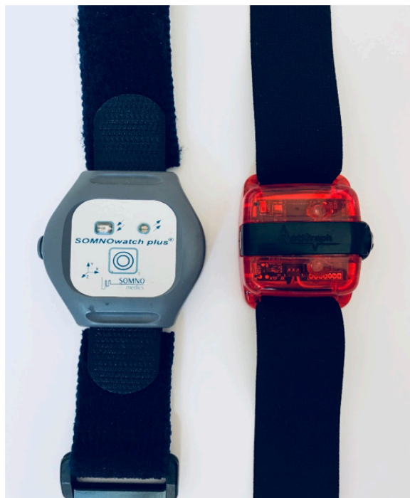
Abbildung 4: Beispiele von Aktigraphen; SOMNOwatch™ plus für das Handgelenk (links im Bild) sowie Aktigraph GT3X+ zum Tragen um die Hüfte (rechts)
