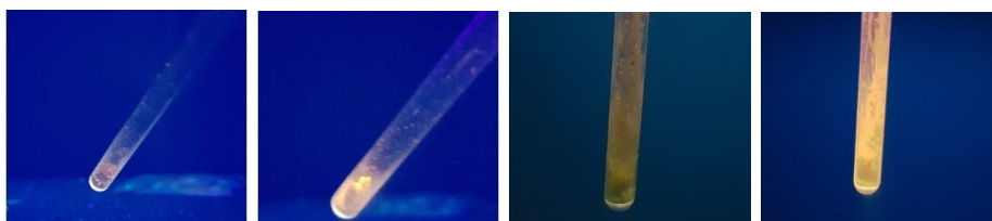
Abbildung 3.83: Lumineszenz unter UV-Licht, von links nach rechts: 8g (RT), 8g ( T = -196\text{ °C} ), 8h (RT) und 8h ( T = -196\text{ °C} ).
