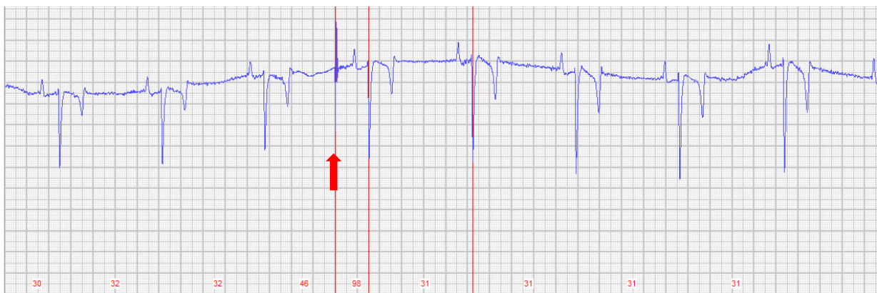
Abbildung 21: Beispiel einer falschen Detektion einer R-Zacke (roter Pfeil).
