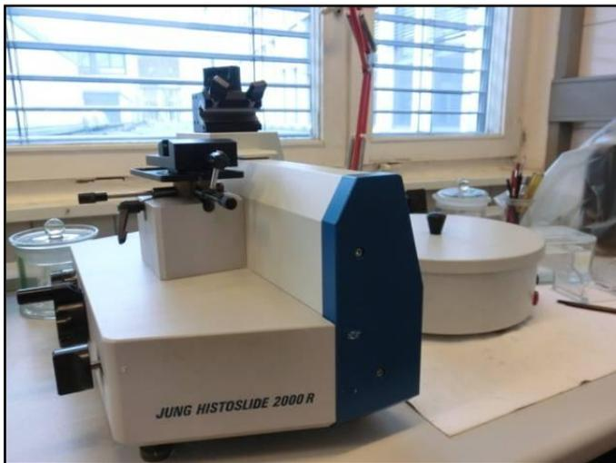
Abb. 2: Schlittenmikrotom (Leica, Jung Histoslid 2000 R)
