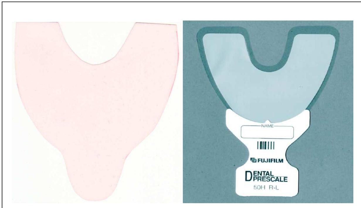
Abb. 14 unbelastete Prescale® Testfolie Typ MS (links) sowie der aus [3] unbelastete Prescale®50H Film Typ R (rechts)
