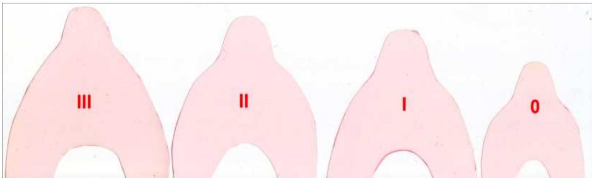
**Abb. 18 Darstellung der unterschiedlichen Prescale® Testfoliengrößen**
