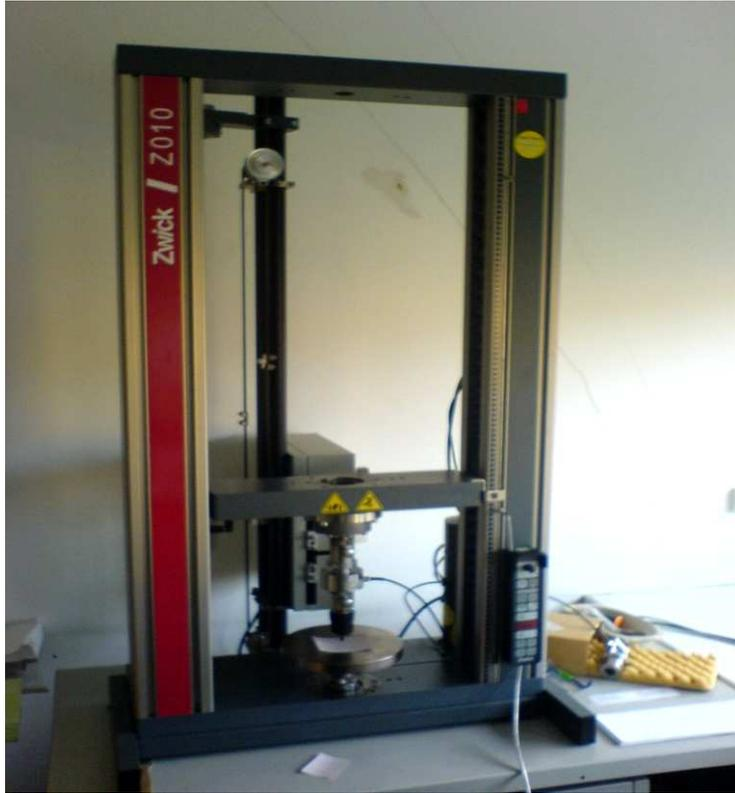
Abb. 19 Darstellung der Druck-/ Zugmaschine Zwick Instron Z010
