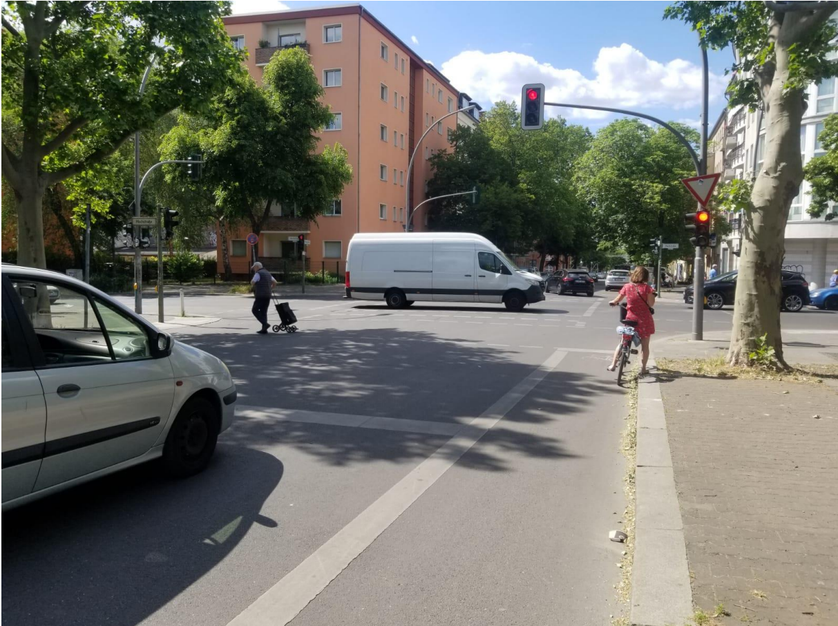
Abbildung 53: Vorverlagerte Haltelinie für Radfahrer an einer Berliner Kreuzung (68)
