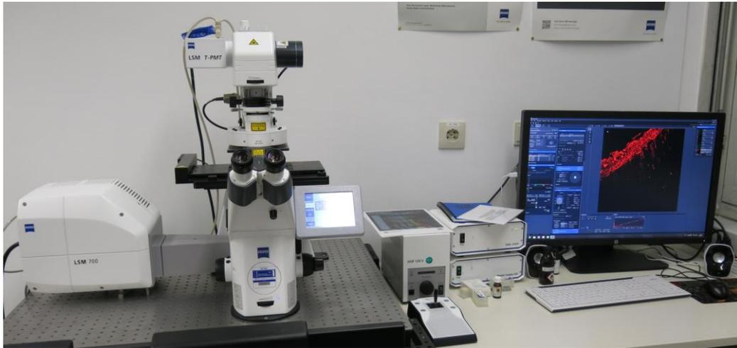
**Abbildung 11:** konfokales Laser-Raster-Mikroskop (LSM 700, Carl Zeiss Microscopy GmbH, Jena)
