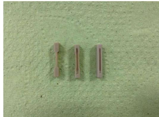
Abb. 2: Kunststoff – Verbindungselemente (Seitenansicht), von links nach rechts 10%, 40% und 100% Steifigkeit.
