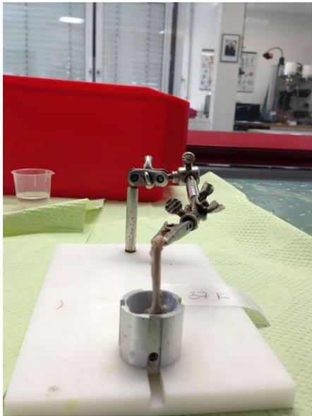
Abb. 13: Haltekonstruktion zur lotrechten und zentrierten Ausrichtung der Probe im Metalltöpfchen.
