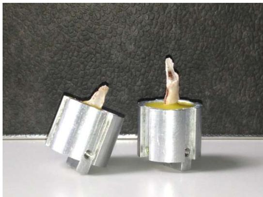
Abb. 18: Frakturierte Probe (Kontralaterale) nach Beendigung der Torsionstestung.
