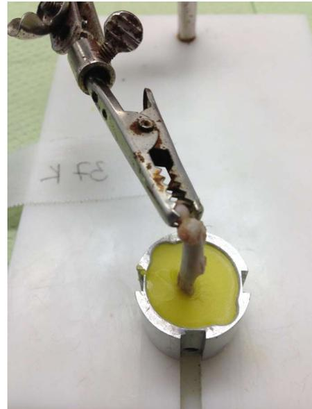
Abb. 14: Einbettung der distalen Epiphyse im ausgehärteten Kunststoff.
