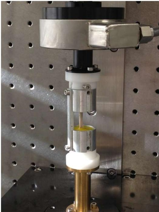
Abb. 17: Positionierung der Knochenprobe parallel zur Rotationsachse der Testmaschine.
