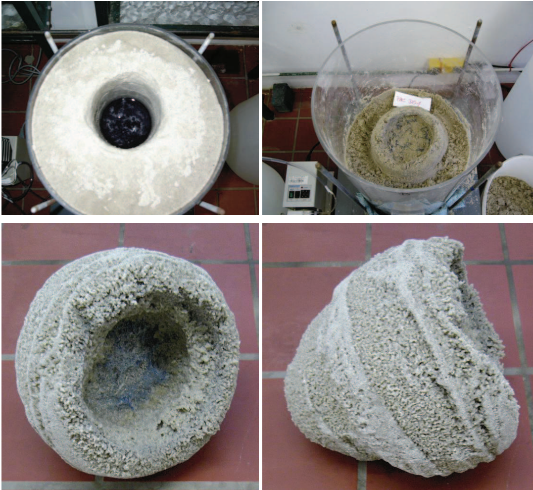
Abbildung 43: links oben: eingefülltes Bauprodukt in die vorbereitete Sandsäule, rechts oben: gebildeter, halb ausgebauter Probekörper, links unten: Aufsicht auf ausgebauten und gereinigtem Probekörper, rechts unten: seitliche Ansicht auf Probekörper
