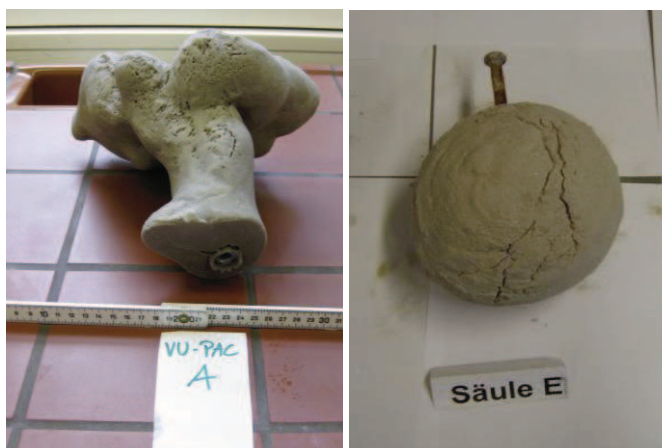
Abbildung 56: Entstandene Injektionskörper der Vergleichsuntersuchung. Die Oberfläche des unförmigen Injektionskörpers wurde mittels Aluminiumfolie bestimmt. Die Werte (oben) zeigen eine deutliche Differenz zwischen rund und unförmig .
