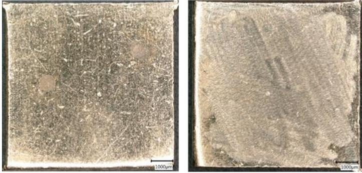
Abbildung 7 Lichtmikroskopische Aufnahme der Legierung Orplid® MH (Fa. C.Hafner) vor dem Abriebtest (links) und nach dem Abriebtest (rechts)
