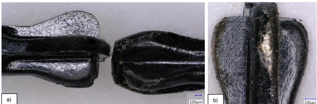
Abbildung 6 Darstellung der Kantenfestigkeit eines PEEK-2-Bohrers; a) links in unbenutztem Zustand, rechts nach Titanabtrag; b) Bohrer mit EM-Partikeln nach dem Abriebtest
