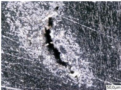
Abbildung 5 Lichtmikroskopische Aufnahme eines Defektes im Bereich des Schaftes eines PEEK-2-Bohrers (300-fache Vergrößerung)
