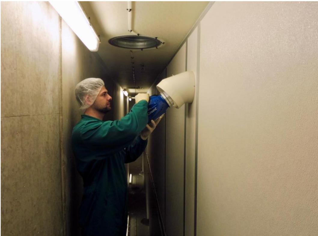
Abbildung 1. Probenentnahme an der Austrittsöffnung des Schlupfbrüters
