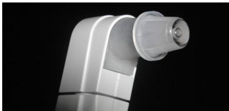
Abbildung 17: Tonometermesskölbchen der dynamischen Konturtonometrie (Pascal®) [61].
