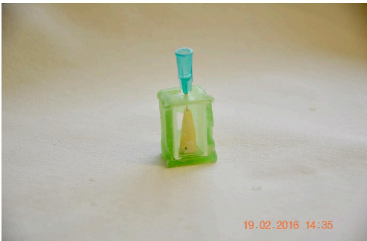
**Abbildung 10** Zur Einbettung vorbereiteter Probenzahn in UV-Küvette zentriert
