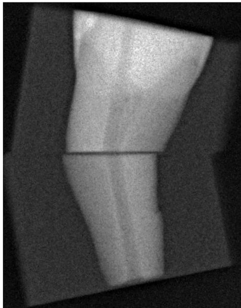
**Abbildung 36** Fügespalt als sichtbare schwarze Linie zwischen koronalem und apikalem Abschnitt
