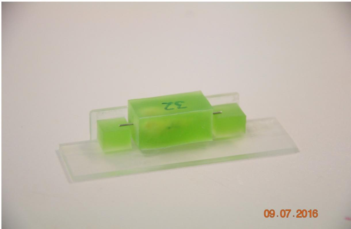
**Abbildung 11** In der Schleifvorrichtung fixierter Probenblock
