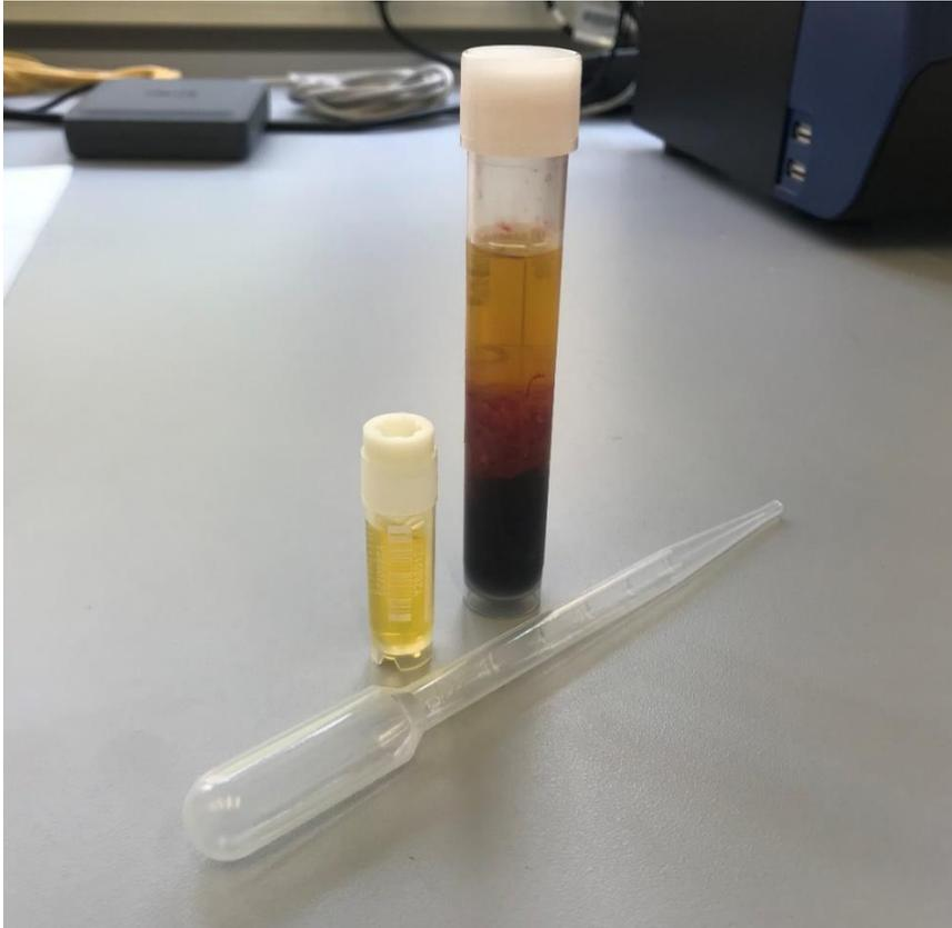
**Abb. 3:** Serumröhrchen, Kunststoffpipette sowie Kryoröhrchen mit Serum zur Kortisolbestimmung.
