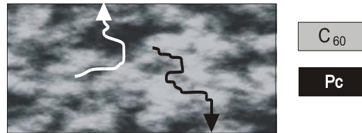
Abbildung III.2: Schema einer C 60 -Phthalocyanin-Mischschicht. Die Pfeile deuten die Transportpfade an, die Elektronen (schwarzer Pfeil) und Löcher (weißer Pfeil) nach der Trennung auf dem Weg zu den Elektroden zurücklegen müssen.
