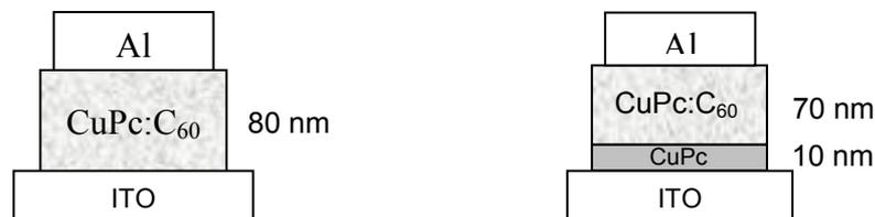
**Abbildung II.25:** Schichtschemaschemata der Solarzellen, die zur Untersuchung der Selektivität der ITO-Elektrode hergestellt wurden. Die ITO-Elektroden wurden jeweils mit Phosphorsäure behandelt oder mit PEDOT:PSS P70 beschichtet wurden.
