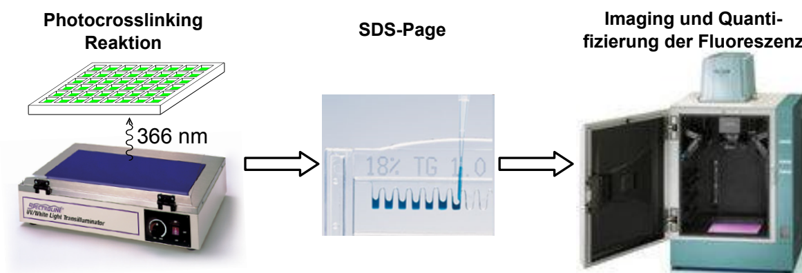
Abb. 7.11.: Ablauf der Photomarkierungsexperimente: Bestrahlung der Reaktionslösungen in einer Mikrotiterplatte mit transparentem Boden mit UV-A Licht, Reinigung der Reaktionsprodukte mit Gelelektrophorese und Dokumentation der Fluoreszenz in den Gelen mit einem Imager.
