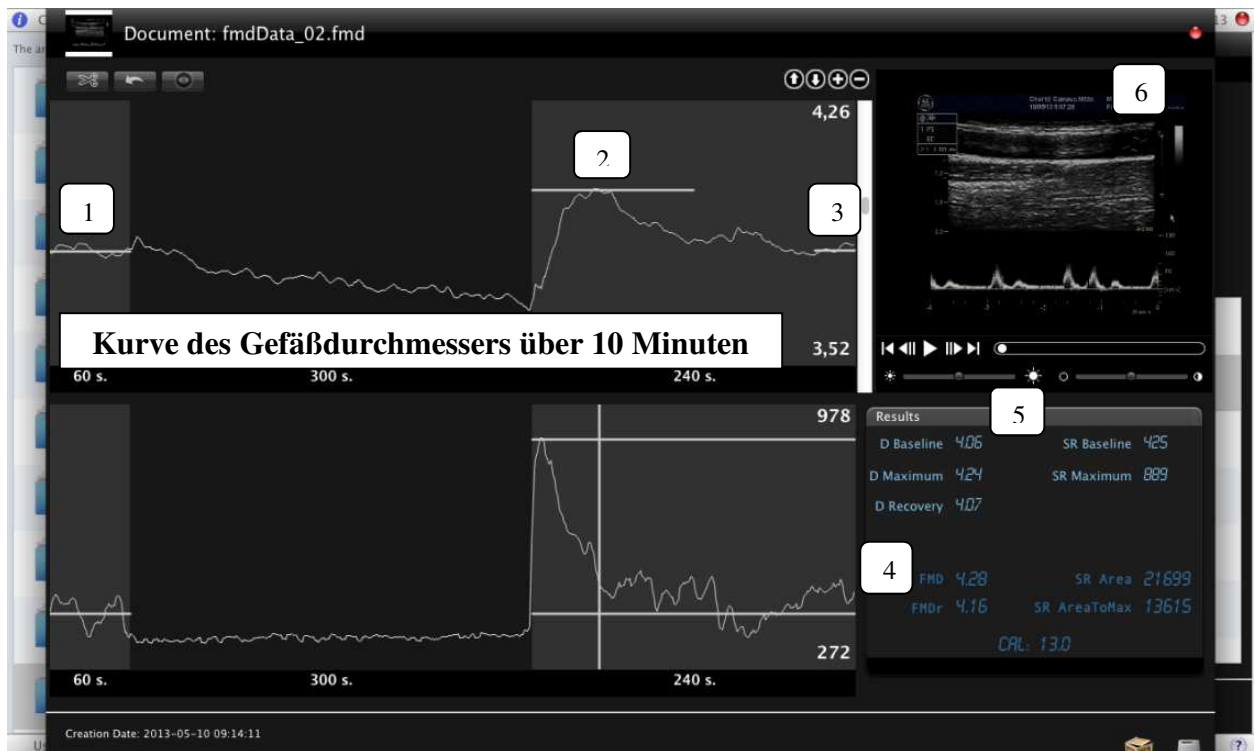
Abbildung 3-4: Beispielscreenshot von einem Dokument einer FMD-Messung 1 – Ruhedurchmesser; 2 – Maximaldurchmesser; 3 – Erholungsdurchmesser; 4 – FMD; 5 – Anzeigetafel der Messwerte; 6 – Videoaufzeichnung des Gefäßquerschnitts
