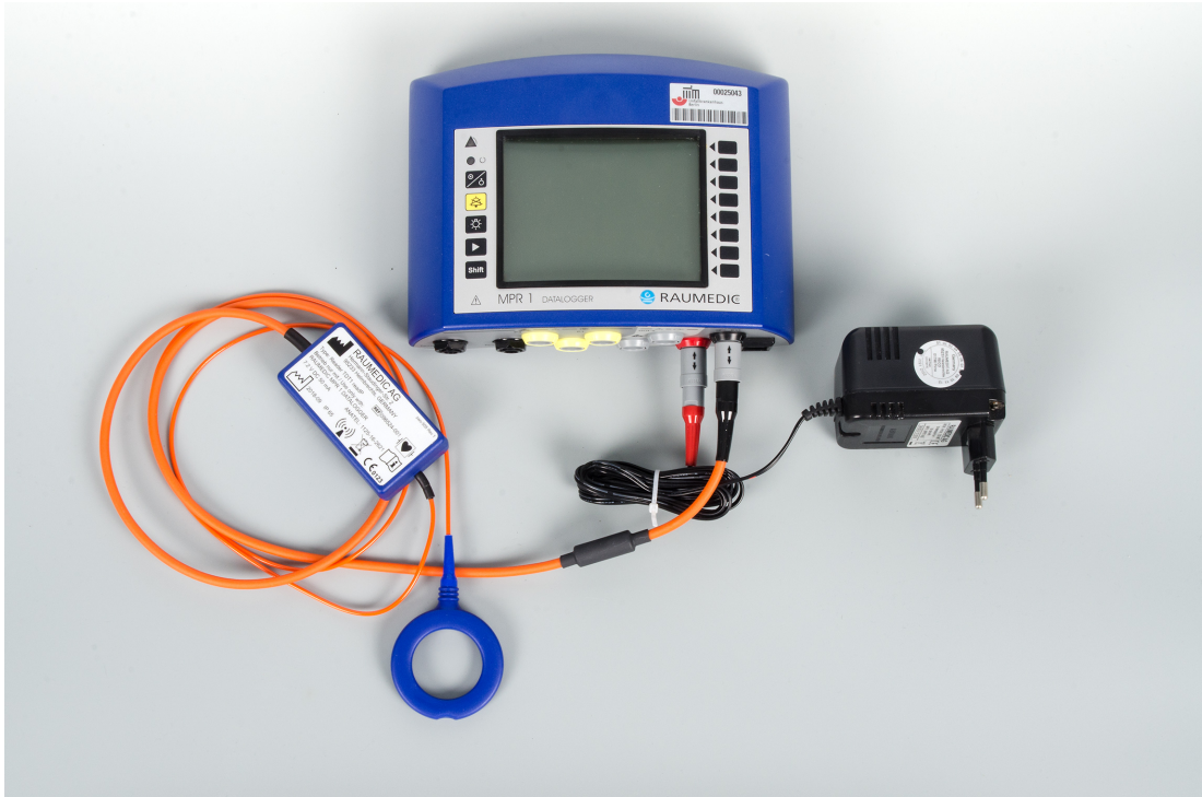
Abbildung 3; Hier ist das Lesegerät (RAUMEDIC TDT 1 readP) zu sehen (A) angeschlossen am Aufnahmegerät (RAUMEDIC Datalogger MPR1) (B). Die ICP-Daten werden von der P-Tel-Sonde auf das Lesegerät elektromagnetisch übertragen. (Foto M. Dweek)
