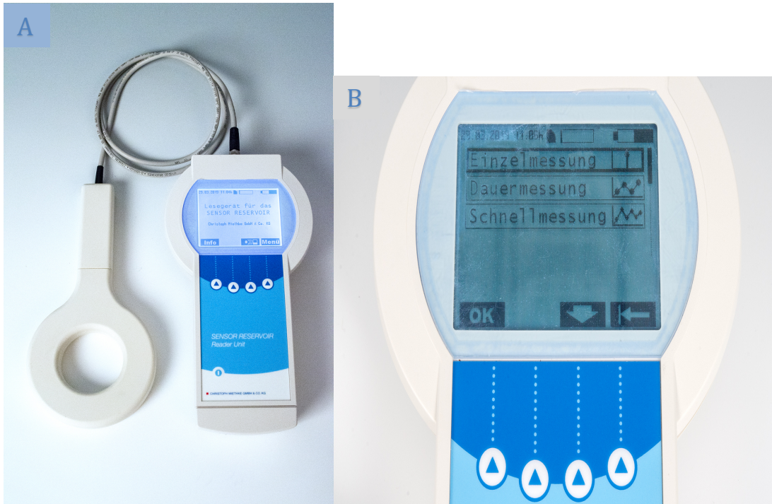
Abbildung 2: A Das Lesegerät für das Sensor-Reservoir mit dem Antennenanschluss. Sobald die Antenne in der Nähe des Sensorreservoirs kommt, werden die ICP-Werte telemetrisch übertragen und auf der SD-Karte abgespeichert. B Die Daten werden in 3 Modi abgespeichert (Einzelmessung, Dauermessung und Schnellmessung). (Foto M. Dweek)
