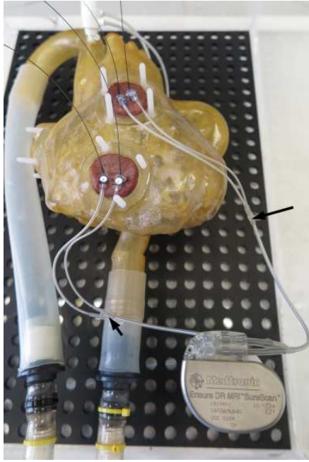
Abbildung 37: Herzmodell mit beispielhafter Füllung des rechtsventrikulären Ausflusstraktes (oberer Implantationsort) und des rechtsventrikulären Apex (unterer Implantationsort), Implantationsweise des epikardialen bipolaren Elektrodentyps 4968, Schrittmacheraggregat in linksabdominaler Positionierung, die beiden Pfeile markieren die Aufzweigung der Elektrodenkabel, unter jedem Elektroden-Ende befindet sich eine Temperatursonde (schwarz)
