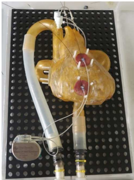
Abbildung 34: Versuchsaufbau mit dem epikardialen unipolaren Elektrodentyp 4965, das Schrittmacheraggregat befindet sich rechtsabdominal, für eine anschaulichere fotografische Darstellung wurde der Deckeleinsatz des rechtsventrikulären Apex (unterer Implantationsort) und statt des rechten Atriums der rechtsventrikuläre Ausflusstrakt (oberer Implantationsort) verwendet, es befindet sich jeweils eine Temperatursonde (schwarz im Bild) unter den Elektroden-Enden
