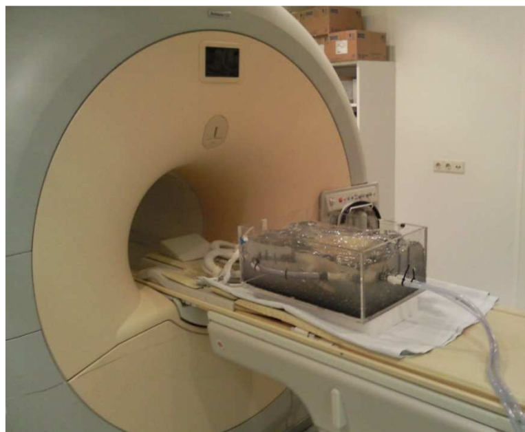
Abbildung 25: Phantom mit Gelfüllung vor dem MRT-Scanner; weiterhin zu erkennen sind die zwei Schläuche für den Durchströmungskreislauf von rechts unten im Bild kommend
