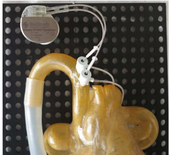
Abbildung 30: Schrittmacheraggregat in rechtspectoraler Positionierung, zwei endokardiale Elektroden 3830 befinden sich über die Nachbildung der oberen Hohlvene über die Schleusen im Herzzinneren
