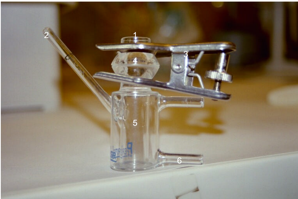
Abb. 3: Foto einer statischen Franz-Diffusionszelle: 1 = Donordeckel (Donorkammer); 2 = Probeentnahmerohr; 3 = Klammer; 4 = Fläche zum Aufbringen der Testmatrix; 5 = Akzeptorkammer; 6 = Zufuhrrohr für den Wassermantel (Temperierung der Akzeptorkammer)
