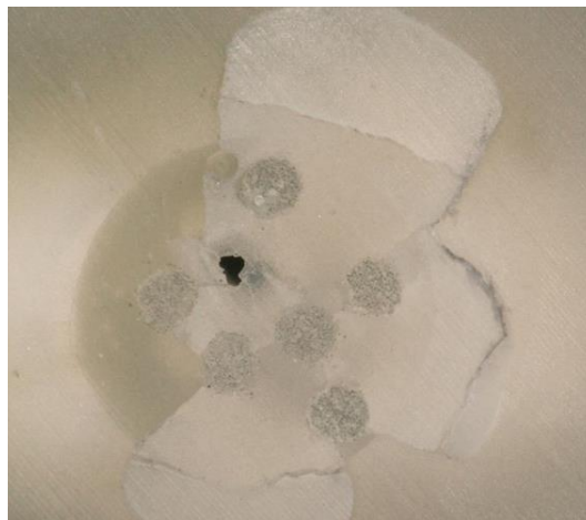
Abbildung 56: Gemischtes Frakturmuster (Rebilda Post GT 6)
