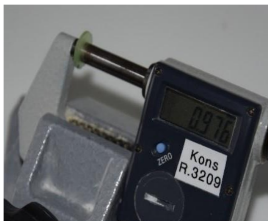
Abbildung 21: Messung der Höhe jeder Dentinscheibe – h (digitales Abstandsmessgerät, Mitutoyo, Mexiko)
