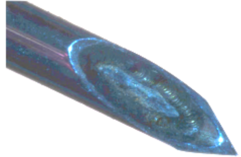
Abbildung 35 b: Prototypkanüle-Facettenanschliffseite unter dem Mikroskop (9,7-fache Vergrößerung)
