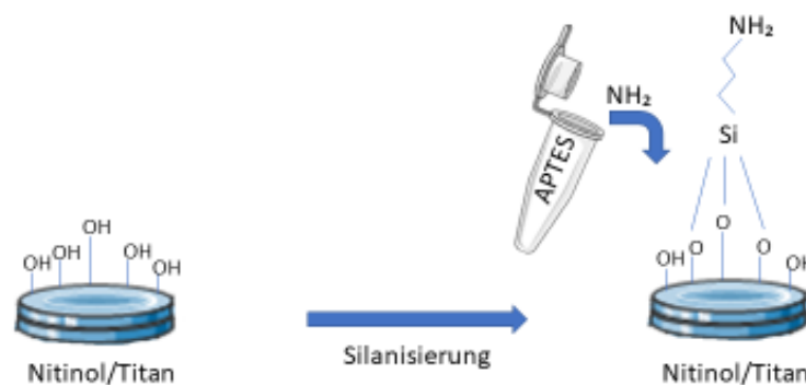
Abbildung 6: Darstellung der Silanisierung der zu beschichtenden Nitinolplättchen durch Zu-gabe von APTES.
