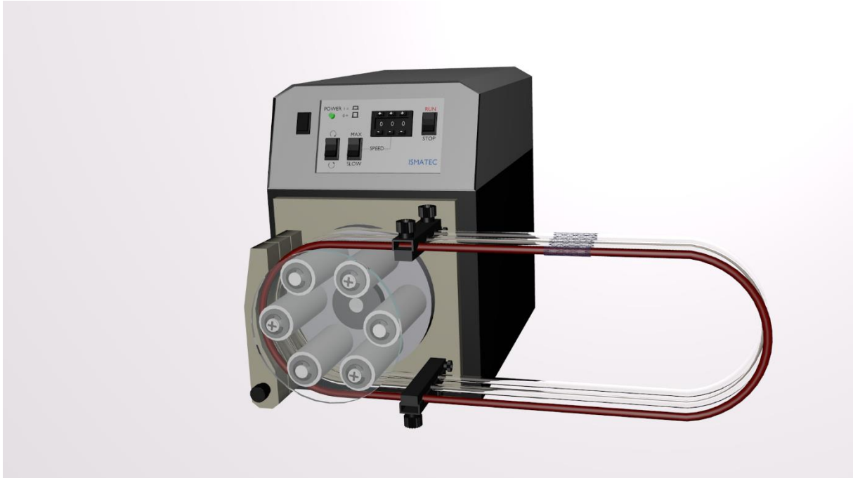
Abbildung 11: Pumpe zur Testung des Materials im Flow Loop. Humanes Spenderblut wurde mittels Pumpe im Schlauch rotiert, um die Stents in der extrakorporalen Zirkulation zu testen. Modifiziert nach (136).
