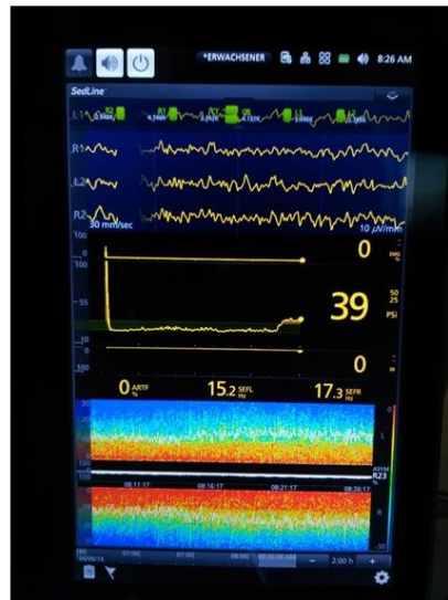
Abbildung 2: EEG basierter Narkosetiefe Monitor mit Darstellung des Roh-EEGs, des Index Parameters sowie unten rechts der Digitalen Spektral Analyse für links und rechts Frontal dargestellt.
