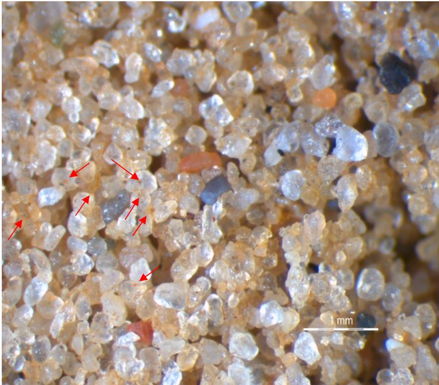
Abbildung 36: Rötliche Flecken auf Quarzkörnern (mit roten Pfeilen markiert) sind Oxidationsflecken (amorphe Eisenhydroxide); Foto: Krömer (2016).
