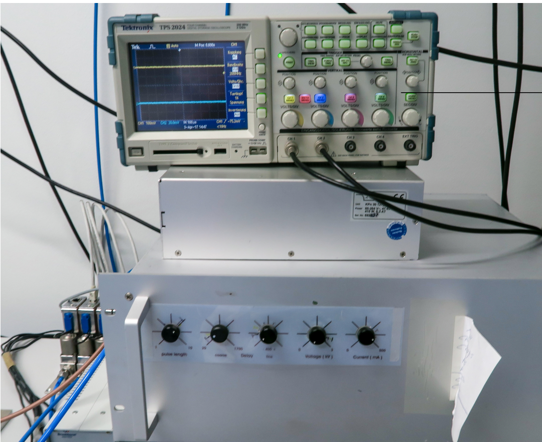
Abbildung 5: Indirektes mikrowellenangeregtes Plasma - Jet - System des IOM Leipzig. 1 = Monitor und Steuerungseinheit des Mikrowellengenerators.
