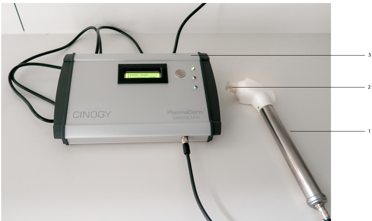
Abbildung 1: Direktes Plasma - System PlasmaDerm® (Cinogy, Duderstadt, Deutschland). 1 = Steuerungseinheit, 2 = CAP - Applikatoransatz, 3 = Handstück.
