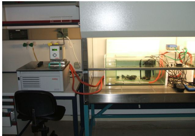
Abbildung 8: Kontaminationsanlage: links Kühlaggregat, rechts Kontaminationsbecken im Kühlbecken (PUND, 2008)
