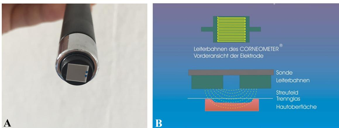
**Abb. 7. Messsonde des Corneometer® CM 825 (A gegenständlich, B schematisch)**
