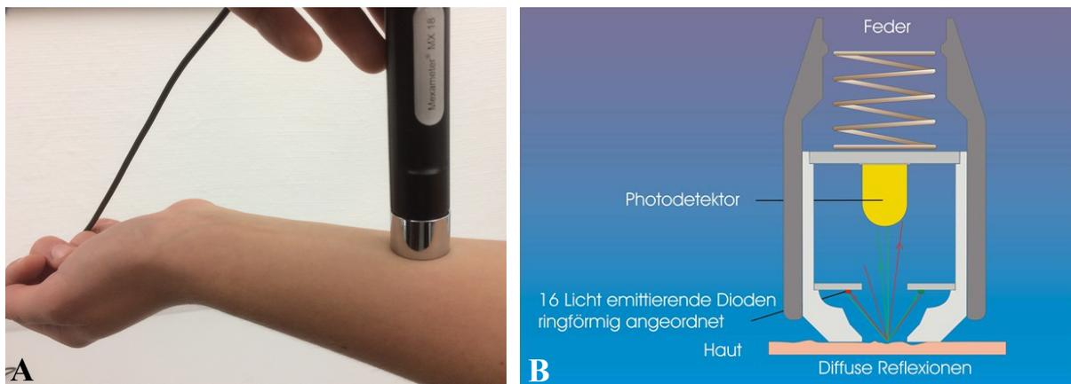
Abb. 6. Messung mit dem Mexameter® MX18 (A gegenständlich am Unterarm; B schematisch)
