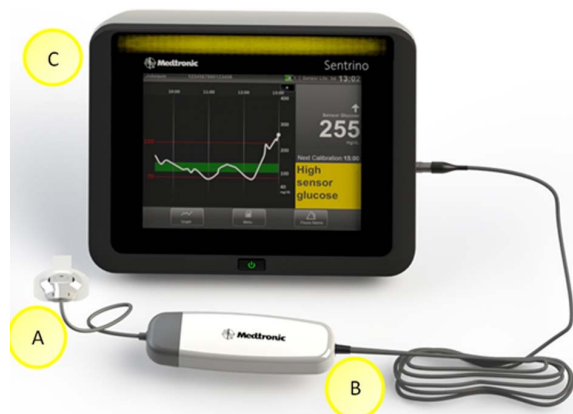
Abb. 3: Aufbau des Medtronic Sentrino®CGM-Systems (Kosiborod et al. 2015) 53
