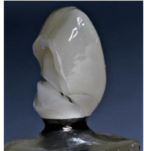
Abbildung 29 zeigt eine weitere Probe mit der Fraktur des Implantataufbaus.
