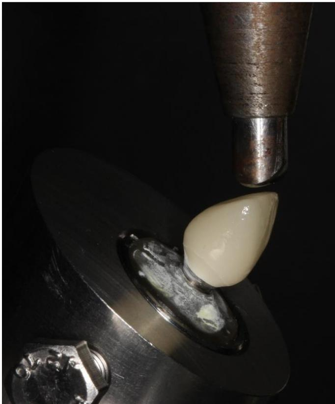
*Abbildung 18: Eingespannte Implantatkrone in der Prüfmaschine. Vor der Belastung wird eine Zinnfolie zwischen Probe und Stempelkopf platziert.*
