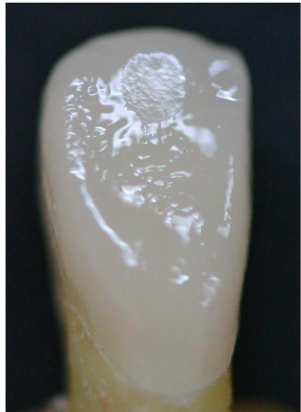
Abbildung 17: Probe nach der Kausimulation. Es sind deutliche Abrasionen unterhalb der Inzisalkante zu erkennen.
