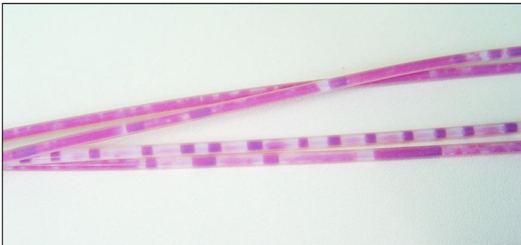
Abbildung 1: Detailaufnahme von fünf mit Prüfanschmutzung kontaminierten Prüfkörpern nach dem Durchdrücken von Raumluft
