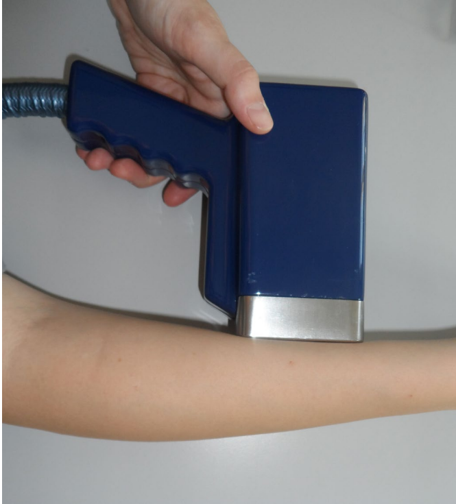
Abbildung 4: Messung eines Hautareals am Unterarm mit dem handgehaltenen Messkopf des optoakustischen Messsystems
