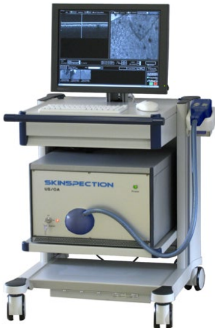
Abbildung 3: Hochauflösendes System zur optoakustischen In-vivo-Bildgebung (Fraunhofer-Institut für Biomedizinische Technik IBMT)
