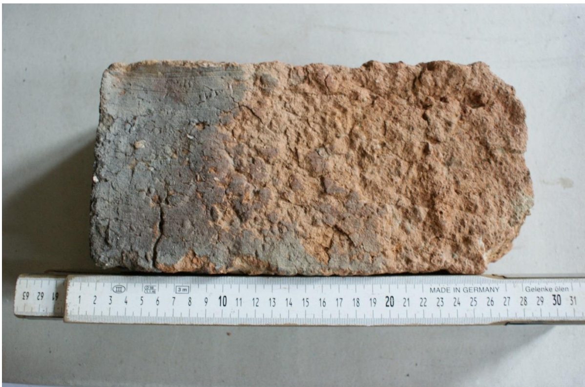
b) SK-Nr. 2013:323/4/1/3: Fehlbrandiger Backstein aus der möglichen Produktionsstätte in Bornstedt. Maße: 28 x 14 x 9,5 cm.
