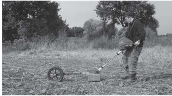
Abb. 277 Georadarmessungen mit der 400 MHz-Antenne auf der Teilfläche 1.
