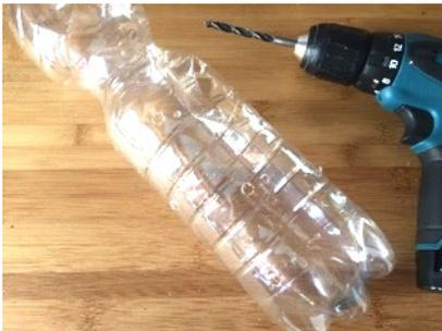
🔧 Bohren Sie mit der Bohrmaschine vorsichtig und langsam Löcher in die Flasche. Lassen Sie das obere Drittel der Flasche aus. Durch die Löcher wird der Kompost gut belüftet.
